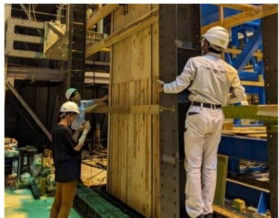
せん断試験後の変形・破壊状況を観察する様子
