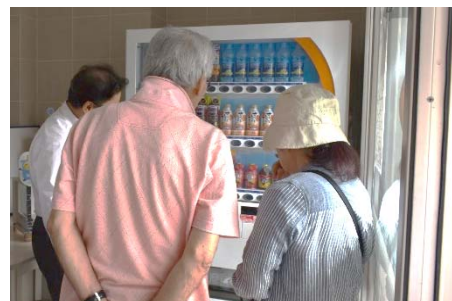
災害時に自動販売機のハンドルをまわし、手動で電気を作ることによって飲料水を取り出すことができる「災害救護ベンダー」
