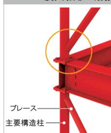
変形を抑えるK型ブレース
