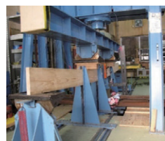
アカマツの曲げ試験の様子
