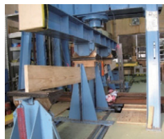
アカマツの曲げ試験の様子
