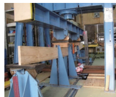
アカマツの曲げ試験の様子
