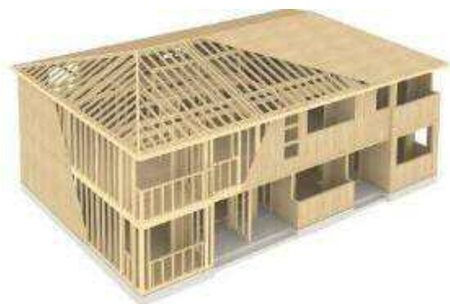
木造2x4工法の構造イメージ
