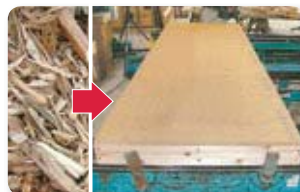
解体発生木材をチップ化し 建材・資材に
