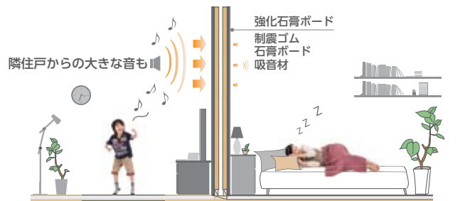
ノイズレスウォールの隣戸間の界壁イメージ
