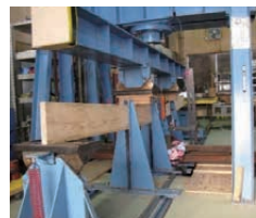
アカマツの曲げ試験の様子
