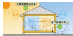
小屋裏及び床下の断熱性能を向上
